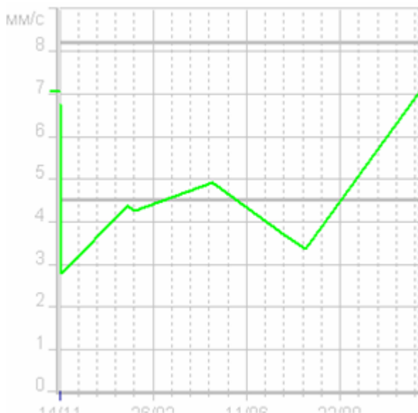
Рис. 194. Отображение аварийного и предупредительного уровня уставок на графике тренда.
