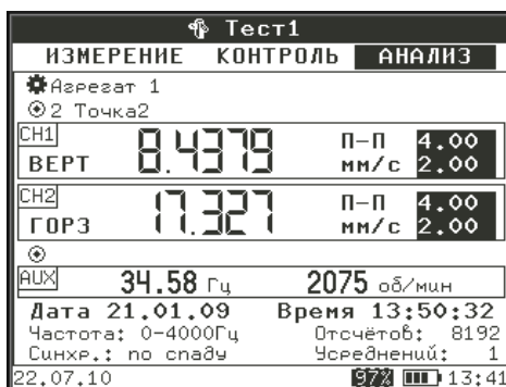
Рис. 45. Окно сбора данных для точки с синхронным сбором с проводимыми ранее измерениями
