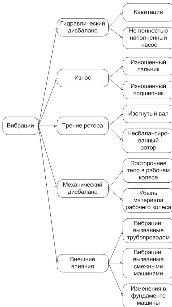
Рис. 247. Неисправности и вредные влияния (на примере питательных насосов), приводящие к образованию механических вибраций
