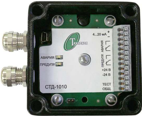
Рисунок 2 - Виброреле со снятой крышкой
